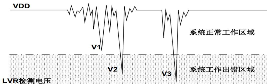
电压跌落可能会进入系统死区。系统死区意味着电源不能满足系统的最小工作电压要求。上图是一个典型的掉电复位示意图。图中，VDD 受到严重的干扰，电压值降的非常低。虚线
