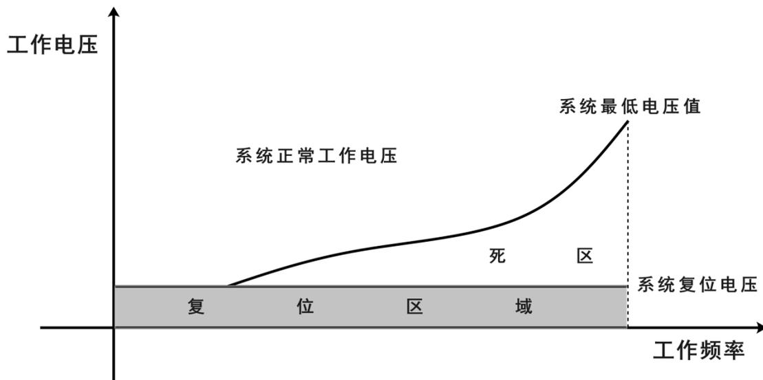
如上图所示，系统正常工作电压区域一般高于系统复位电压，同时复位电压由低电压检测（LVR）电平决定。当系统执行速度提高时，系统最低工作电压也相应提高，但由于系统复位电压是固定的，因此在系统最低工作电压与系统复位电压之间就会出现一个电压区域，系统不能正常工作，也不会复位，这个区域即为死区。
