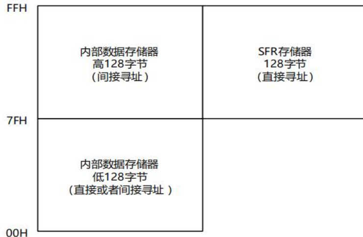
内部数据存储器结构图
