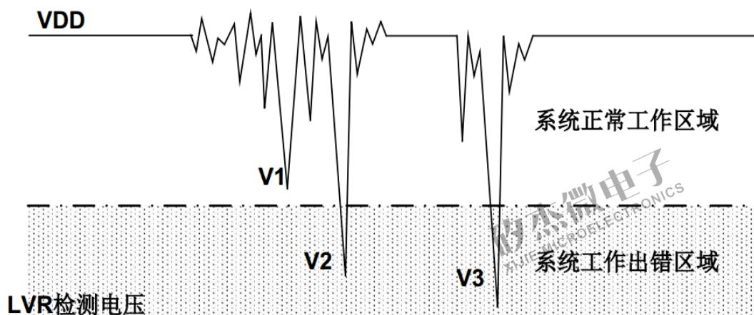
电压跌落可能会进入系统死区。系统死区意味着电源不能满足系统的最小工作电压要求。
