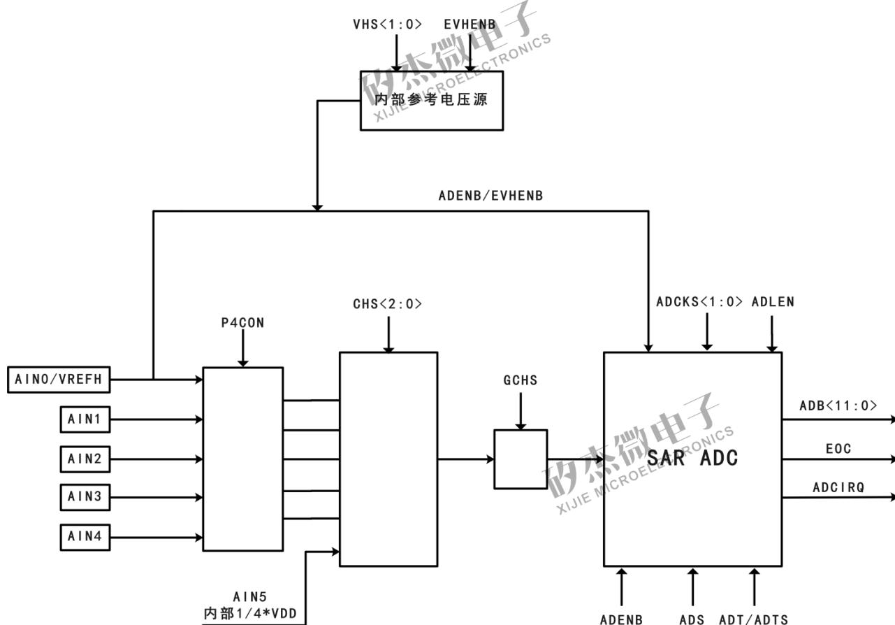
ADC 电路结构示意图
